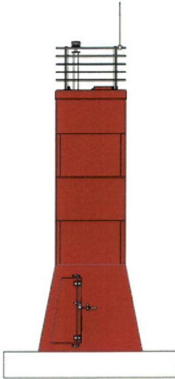
Figura A2: Torre de fibra de vidrio tipo estribor de 6 metros de altura.
