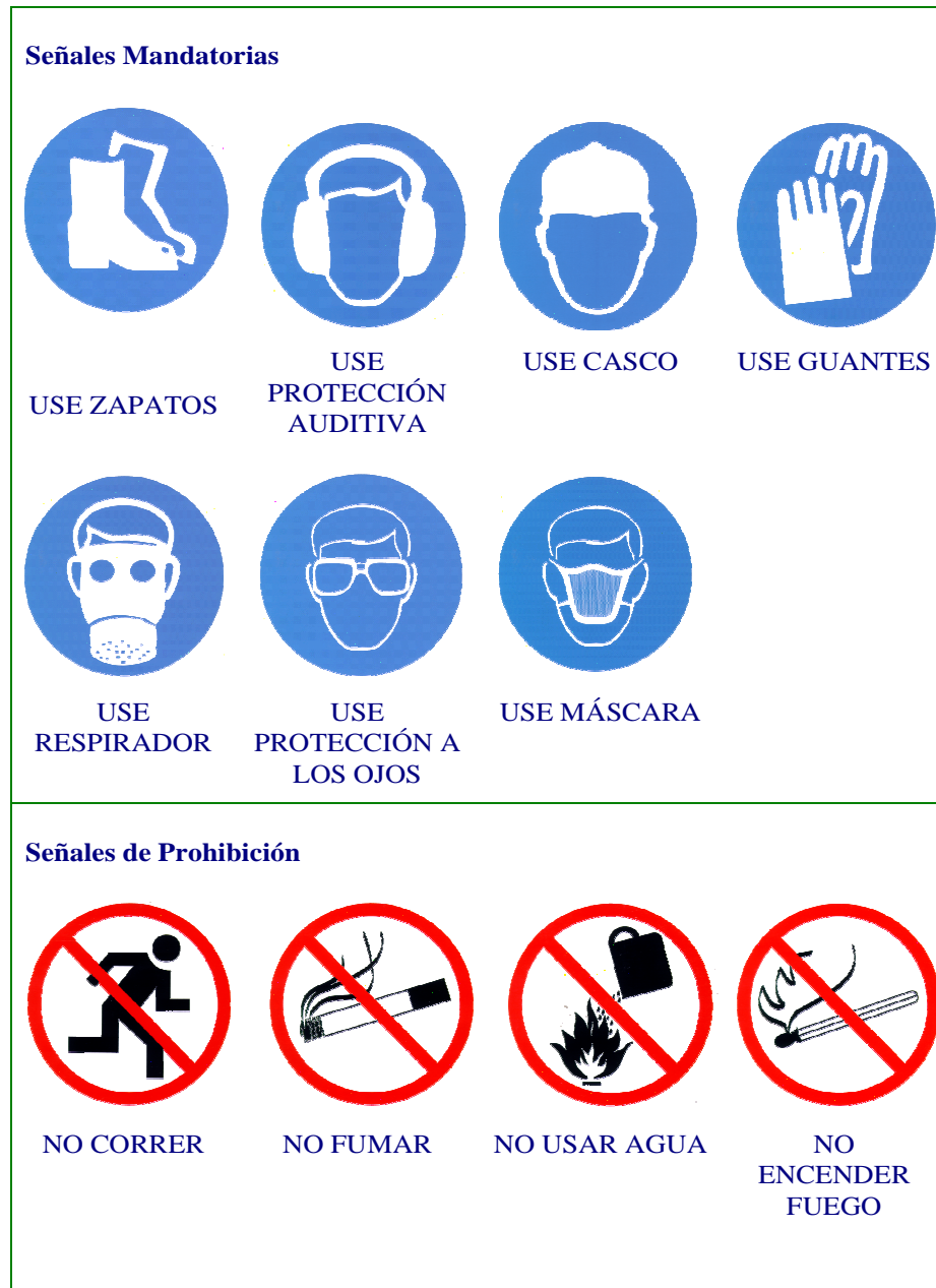
FIGURA 13 SEÑALÉTICA DE PREVENCIÓN DE RIESGOS
